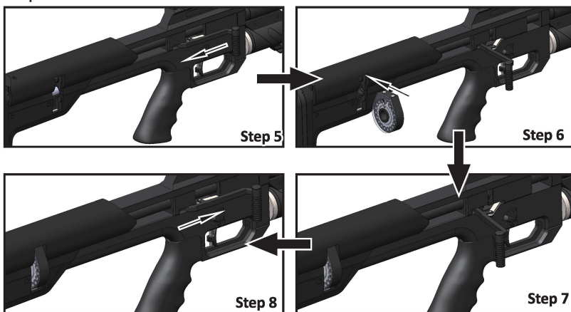
OBR. 12 - vložení zásobníku do zbraně
