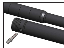
OBR. 10 - vložení plnicího pinu
